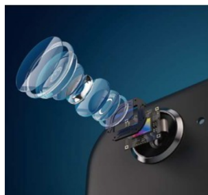
※スマートフォンカメラモジュール構造のイメージ図
