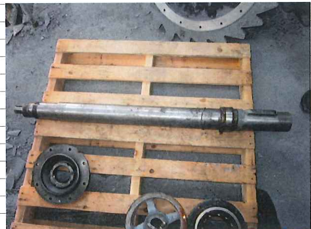
写真-6. シャフト取外し
