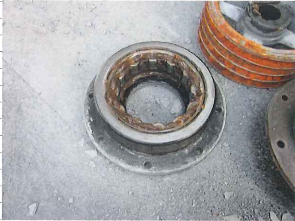
写真-7. 反駆動側軸受外輪取外し
