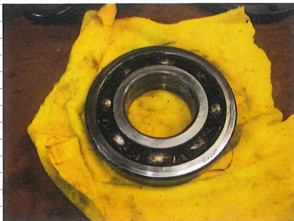
写真-5. 反駆動側軸受状況
