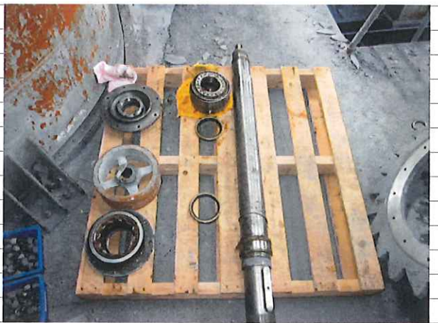
写真-10. 分解完了
