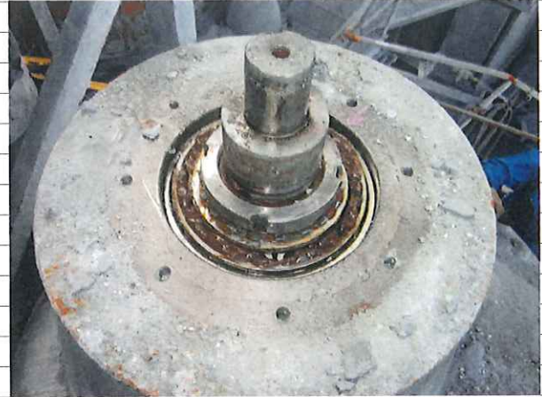
写真-2. 駆動側軸受状況
