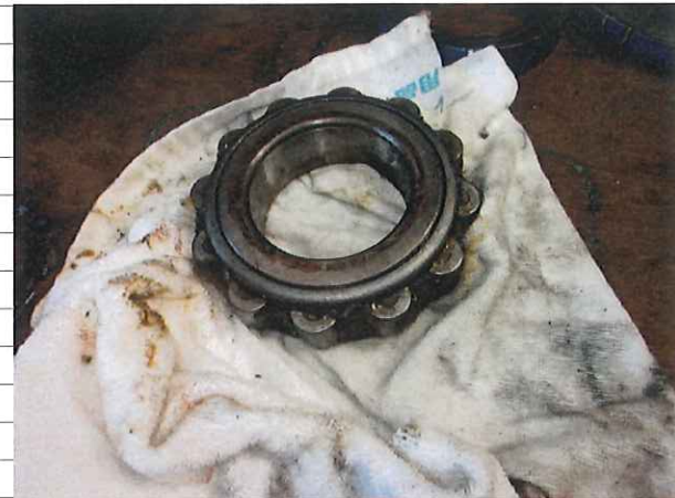
写真-4. 駆動側軸受状況
