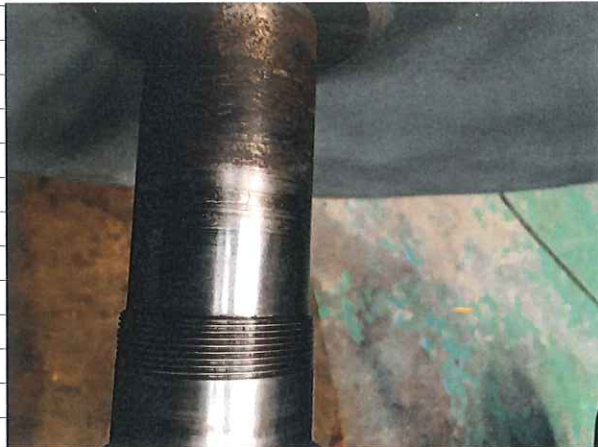
写真-13. シャフト軸封部摩耗状況
