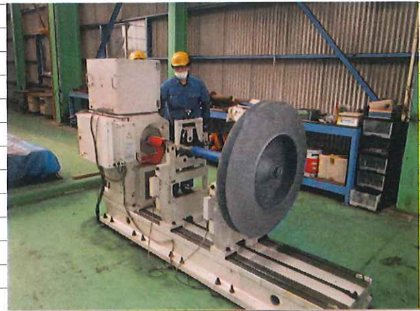
写真-12. サンドブラスト後バランス計測
