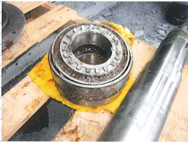
写真-9. 駆動側軸受取外し
