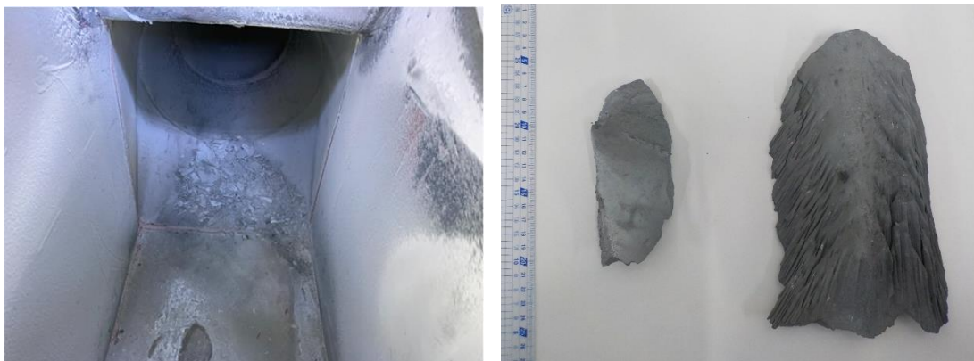
図 2 4 分級ファンケーシング下部の亜鉛末スケールの破片、塊写真
