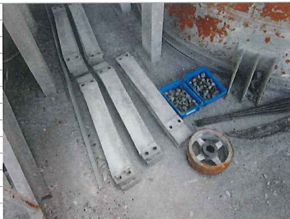
写真-3. 分級羽根取外し
