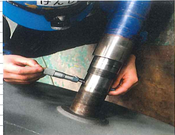
写真14. シャフト軸封部摩耗計測
