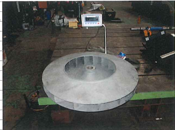
写真-10. サンドブラスト後重量計測
