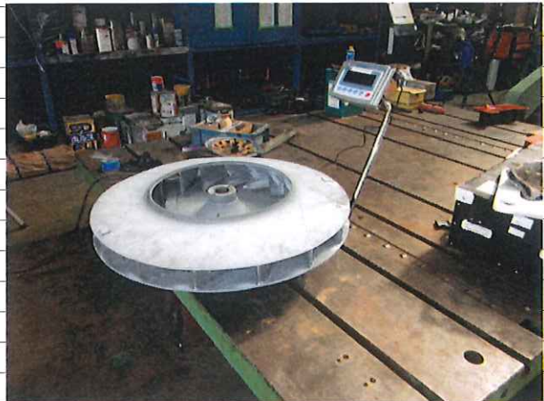
写真-6. サンドブラスト前重量計測
