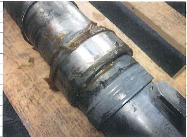
写真-8. 反駆動側軸受内輪状況
